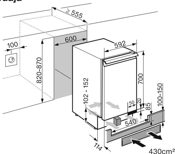
Prije ugradnje se uvjerite da je ugradbena niša u skladu sa zadanim dimenzijama za ugradnju. Poprečni otvori za prozračivanje i odzračivanje moraju biti izvedeni prema nacrtu i izrez u maski podnožja za priloženu ventilacijsku rešetku mora biti centriran prema uređaju, kako bi se jamčila korektna funkcija uređaja.
