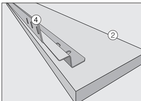
Da biste pričvrstili pokazivač za izjednačavanje potreban Vam je kutnik za pričvršćenje ④. Može se nabaviti u Miele prodavaonicama ili Miele servisu. Kutni pričvrсни element možete prema potrebi montirati na ili ispod uređaja.
